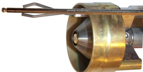
Elektrodenabstand 4 mm
