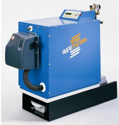
VERITHERM Voll-Brennwertkessel Typ 40, 25-40 kW, Öl-Blau/Gas-Brenner, Umwälzpumpe, Abgasgebläse, Vierwegemischer, Neutralisationsanlage mit Granulat, isolierte Kompaktverrohrung mit allen sicherheitstechnischen Einrichtungen, Steuerung VST 2001
