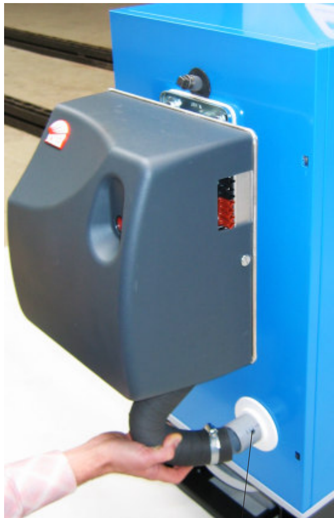
Messung der Verbrennungslufttemperatur
