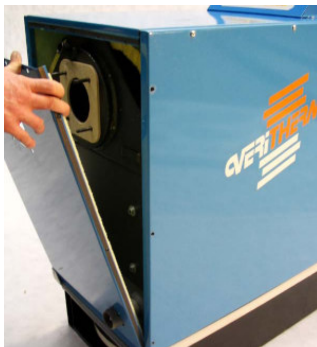
Bild 3-8: Vorderwandabdeckung aus der Bodenwanne heben und abnehmen.
