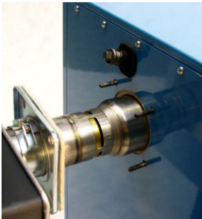
Bild 3-6: Brenner mit Glührohr vorsichtig aus der Brennkammer herausziehen.
