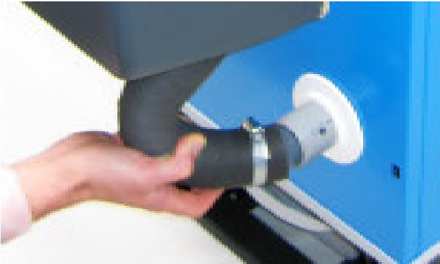
Bild 3-4: Zuluftschlauch abziehen. Die Öffnung zur Messung der Verbrennungslufttemperatur ist während des Betriebes durch den Schlauch verdeckt.
