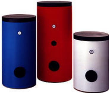
Stehender Trinkwassererwärmer mit eingeschweißter Heizwendel; Korrosionsschutzemaillierung des Behälters und der Heizwendel; auswechselbare Magnesiumanode; Kontroll-/ Reinigungsöffnung; Brauchwasser- und Heizungswasseranschlüsse seitlich angeordnet; eingeschweißte Tauchhülse für Temperaturerfassung; Thermometer; Poly-Deckel; Poly-Flanschabdeckung mit Isolierung; Lieferung auf Einwegpalette in Wickelfolie eingeschumpft.
